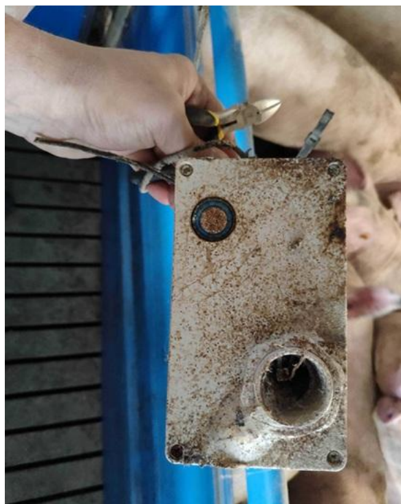
Zdjęcie 2. Czujnik składu powietrza po roku użytkowania (Czech, 2023).
