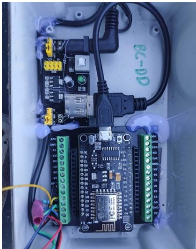
Zdjęcie 1. Wnętrze czujnika do pomiaru warunków środowiskowych w chlewni (Czech, 2023).
